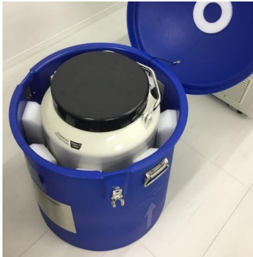
液体窒素を用いた輸送容器 ドライシッパー
